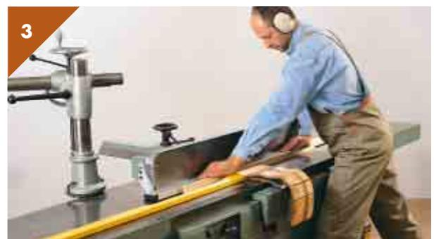
Flachen Hilfsanschlag in Arbeitsstellung schwenken oder Winkelhilfsanschlag am Fügeanschlag sicher befestigen.
