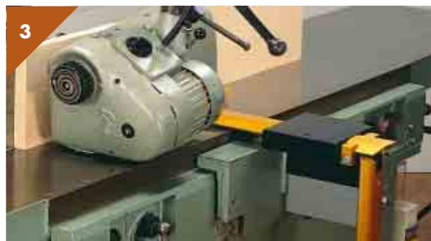
3 Zum Fügen von Werkstücken den Vorschubapparat zum Anschlag hinschwenken und leicht schräg zum Abnahmetisch einstellen.
