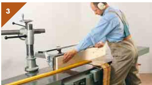
Vor dem Fügen (Anhebeln von Winkelkanten an hochkant zugeführte Werkstücke) den Fügeanschlag auf den vorgesehenen Winkel einrichten.
