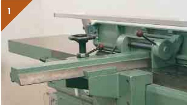
1 Anschlagführung ist gleichzeitig Messerwellenverdeckung
